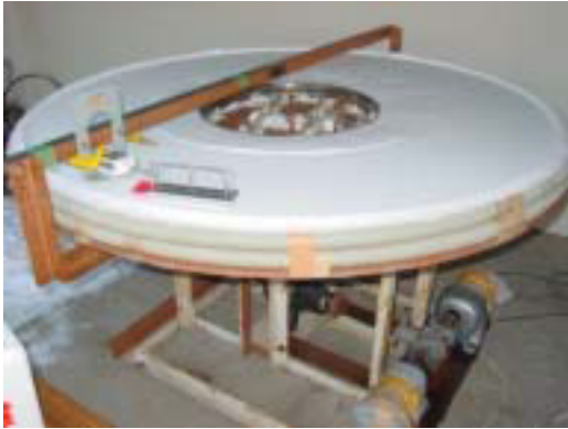
(b) モデルスキーがトライボメータの平坦な雪面上を滑走している。
