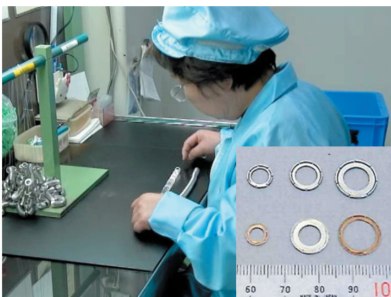
図1 匠級検査員の作業の様子 右下は検査対象のプレス部品
