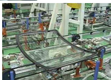
ガラスプライマー塗布検査（ロボットの先端にカメラを取り付け、ガラスプライマーのかすれを画像検査）
