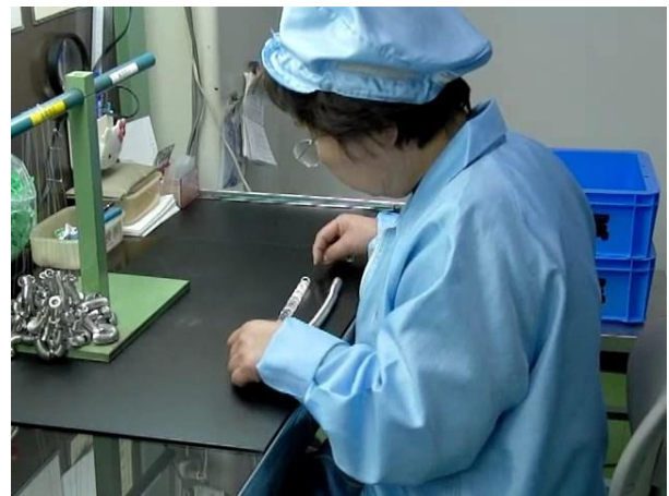
匠級検査員による目視検査の様子
