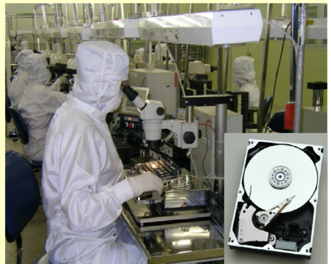
HGA(Head Gimbal Assembly)の目視検査
