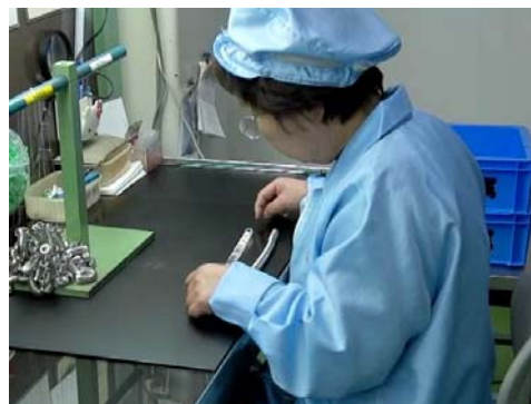
プレス部品の外観目視検査
